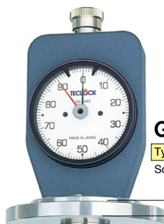
GS-743G Type E2 Durometer Soft rubber
